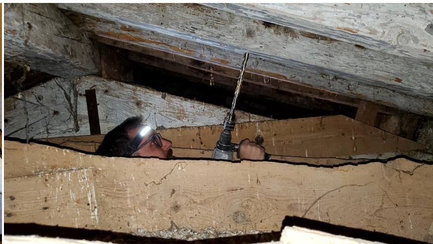
Prélèvement dendrochronologique par carottage d'un chevron
