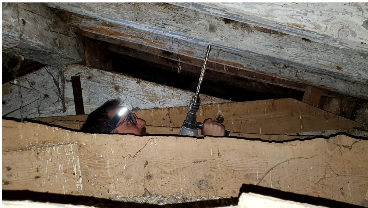
Figure 7 : Prélèvement à la tarière mécanique dans le « Chevron2 » (Cliché : F. Blondel).
